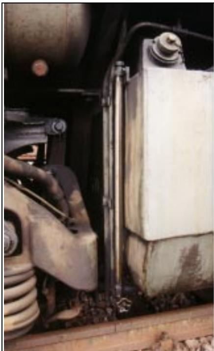
Abb.1: Glasrohranzeiger an einem Dieselloktank
