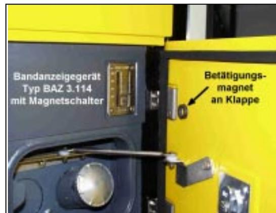
Abb.7: Anordnung eines Bandanzeigergerätes Typ BAZ 3.114 mit Magnetschalter unter einer Klappe
